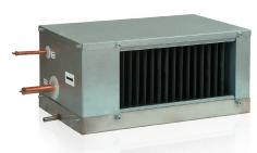
предотвращает попадание в канал капель конденсата, срывающихся с трубок охладителя потоком охлаждаемого воздуха. При выборе охладителя необходимо учитывать, что каплеуловитель эффективно улавливает конденсат при скорости воздуха не превышающей 4 м/с.
